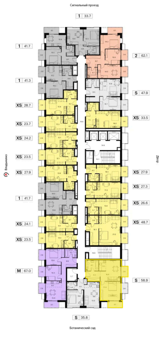
Корпус 1 План 8-15, 17-23 этажа
